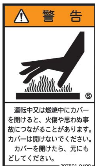
⑧ 火傷警告マーク
