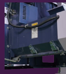
昇降機入口底板 パッチン固定方式
