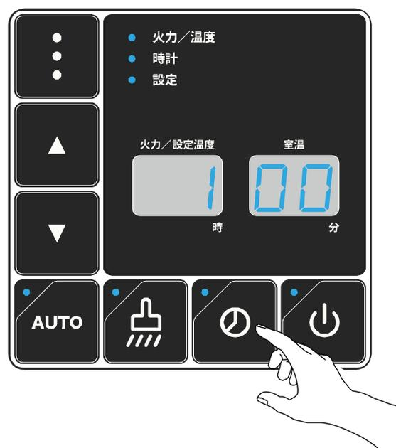
**4** 燃烧空気の風量を強くしたい場合は ▲ を、弱くしたい場合は ▼ を押して調整します。
