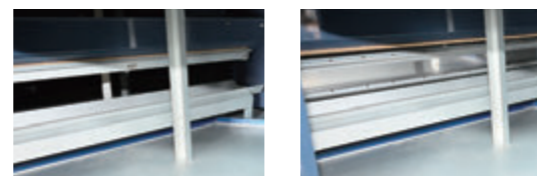
下スクリー樋を閉じた状態 下スクリー樋を開いた状態
