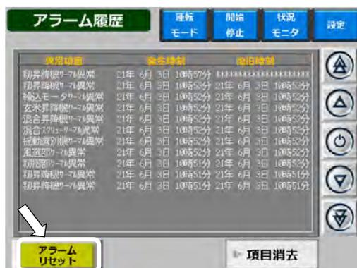
④ パトランプが点灯に替わったら、画面上部の「運転モード」ボタンを押して、最初の画面にもどり、運転を再開してください。
