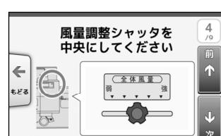
(d) [風量調整シャッタ] のツマミを回して緩め、[中央位置] にします。
