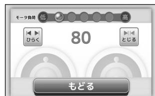
(a) ロール開閉モータが回りロールすきまを約8mmにします。
