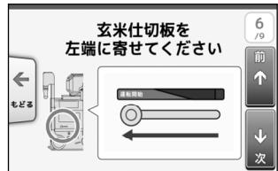
(f) [玄米仕切板] のツマミを [運転開始位置] にします。
