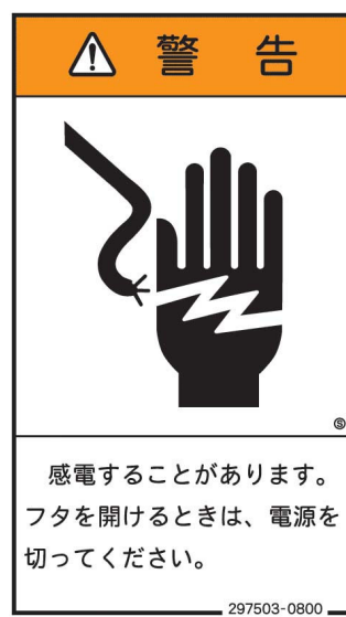
⑱ 感電警告マーク
