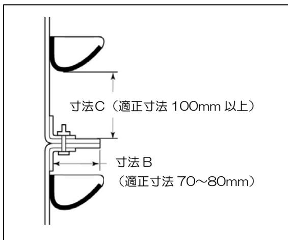
③ バケットベルトの継ぎ目とすぐ上のバケット底部との間隔(=寸法C)が100mm以上あるようにしてください。
