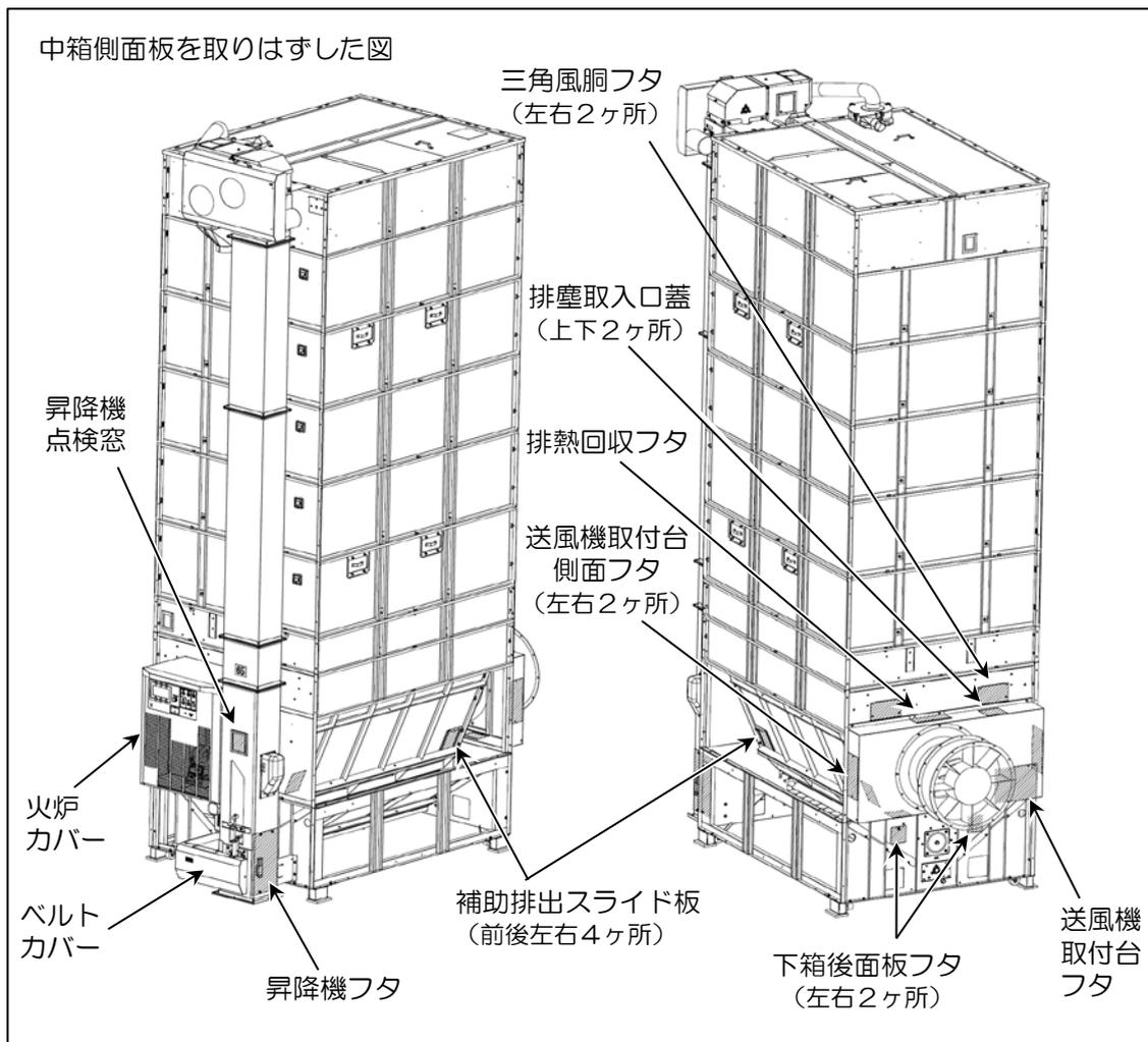
① ベルトカバー、火炉カバー、昇降機フタが取り付けられていることを確認してください。
