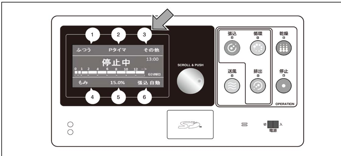
② ダイヤルを回し、カーソル“□”を移動させ、設定を変更します。
