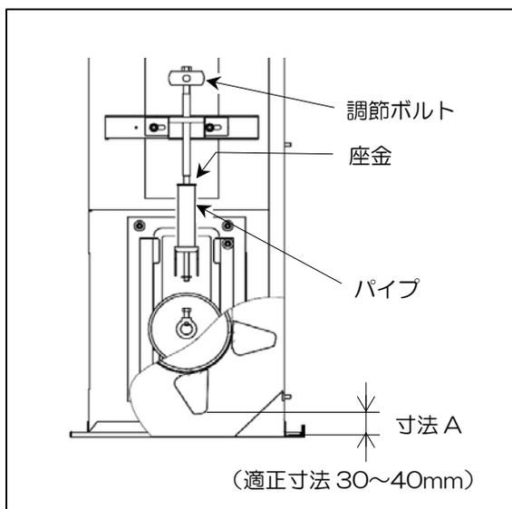
⑤ 左右の調節ボルトをゆるめる方向に調節して、バケットが昇降機の中央を走るようにしてください。
