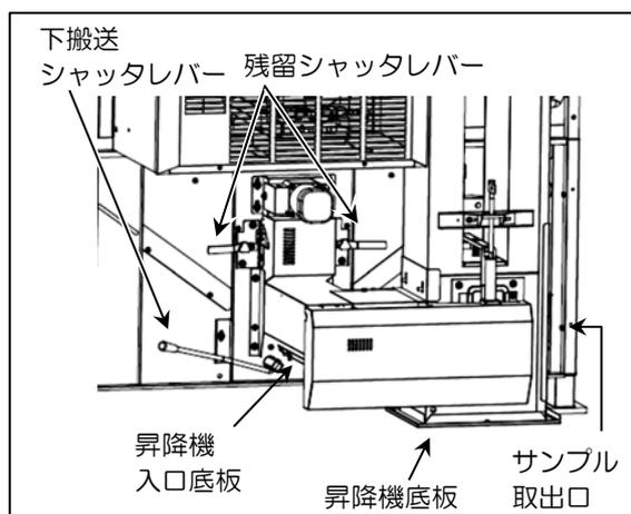
③ 残留シャッターレバー、下搬送シャッターレバー、昇降機入口底板、サンプル取出口および昇降機底板が閉じられていることを確認してください。
