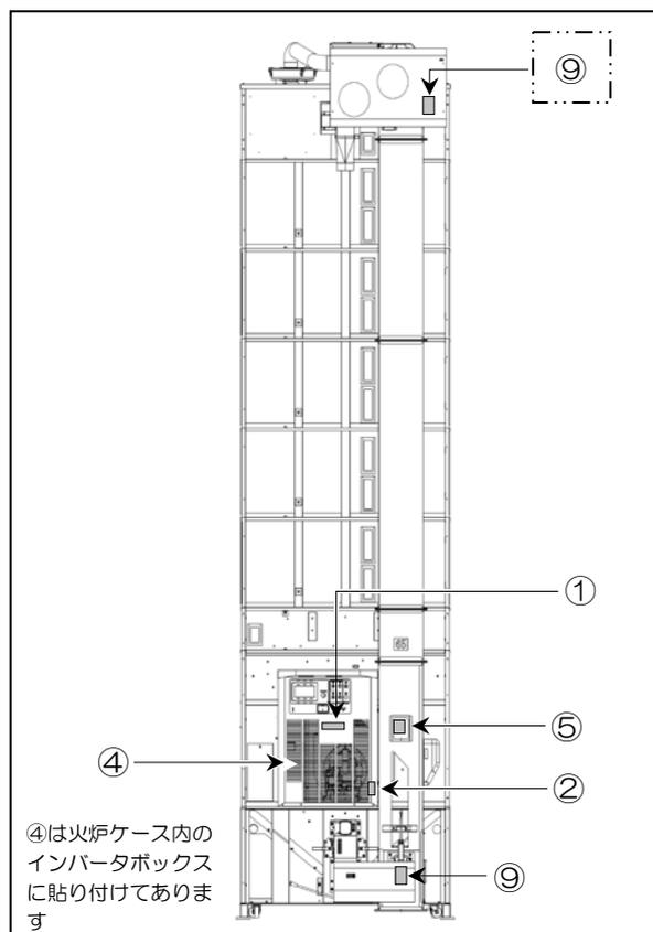
④は火炉ケース内のインバータボックスに貼り付けてあります
