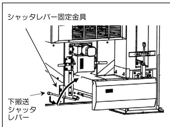
④ ノブボルトをはずし、左右の残留シャッタレバーを『開』の位置まで上げてください。
