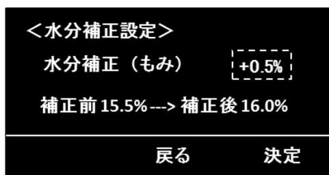
④ ダイヤルで目標設定値に変更し、[⑥キー] を押します。(右図の□□□ は、□□□ が点滅状態を示します。)
