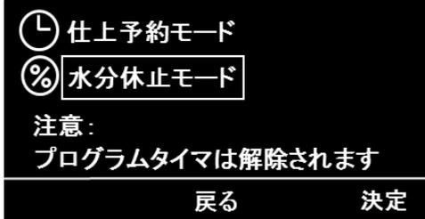
② ダイヤルを回し、水分休止モードにカーソル“口”を合わせ、[⑥キー]を押します。
