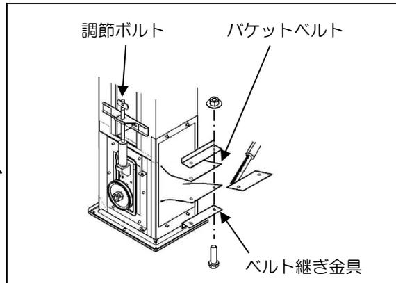
② ベルトの継ぎ代は、バケットの巾程度の長さ（＝寸法B）を70～80mm残して切り取ってください。
