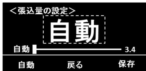
② 枠が点滅しているとき、ダイヤルを回すと自動から数字に変わり、さらにダイヤルを回すと数値が上下できます。
