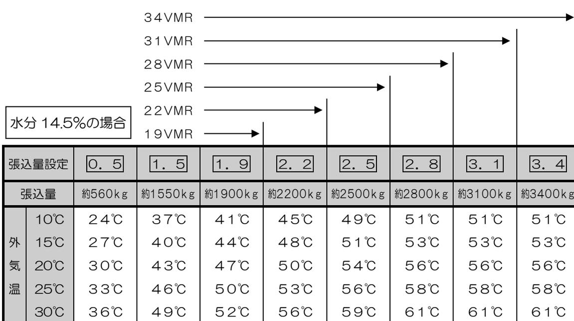
（注）この表での外気温とは、操作盤に接続された気温サーミスタで検知した温度をいいます。
