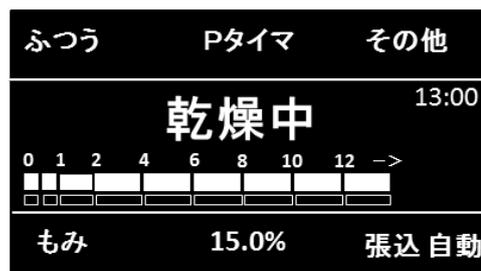
② 乾燥運転中の「その他の設定変更」画面になります。「水分補正」にカーソル” □ ” が合わせてあることを確認し [⑥キー] を押します。
