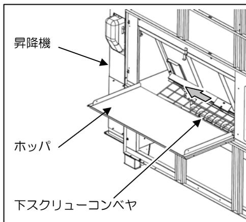
② 逆方向に進行している場合は、元電源側のコンセントからプラグを抜いて、プラグのE（アース）を除くR・S・Tのうち2個所を入れ換えて結線します。プラグの結線の入れ換えは、購入先に依頼してください。
