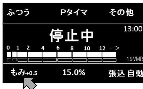
例：乾燥終了後、本機の表示水分が16.0%で手持水分計の表示水分が15.4%の場合、本機の表示水分を「-0.6%（本機の表示値から0.6%引く）」補正します。
