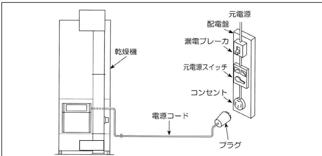
① 元電源および電源コードに、アースが接続されていることを確認してください。
