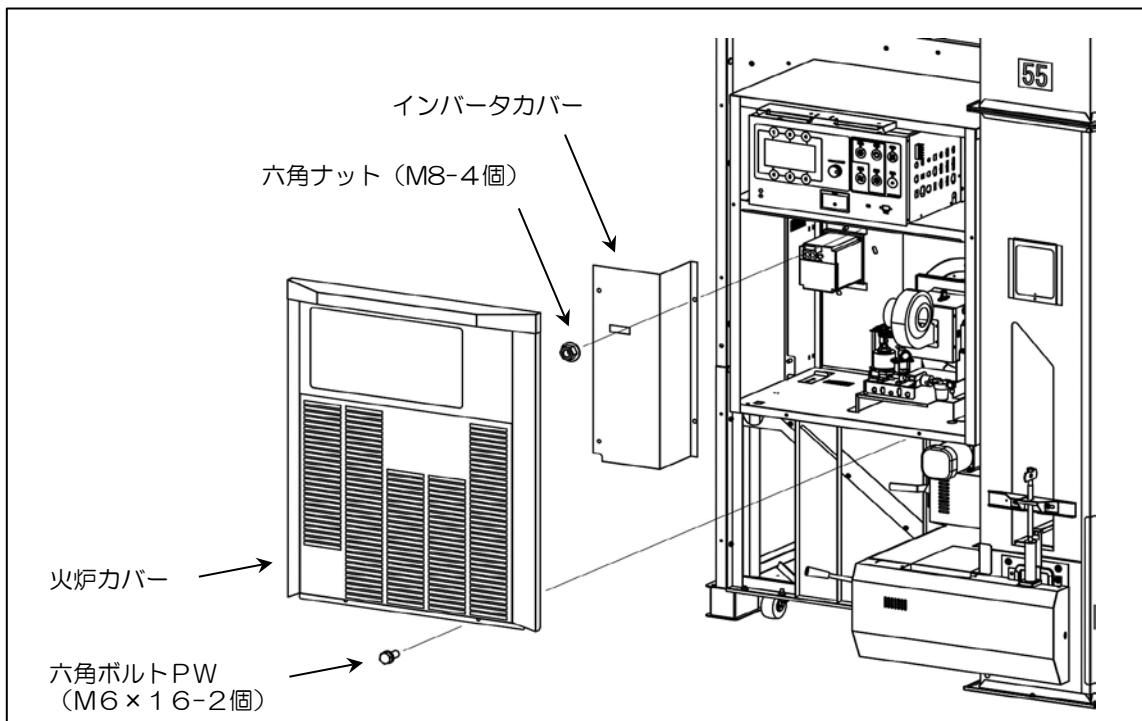
⑥ インバータ本体の端子カバーの、下端を持ち上げてはずしてください。
