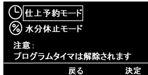
② ダイヤルを回して「仕上予約モード」にカーソル“□”を合わせ、[⑥キー] を押します。
