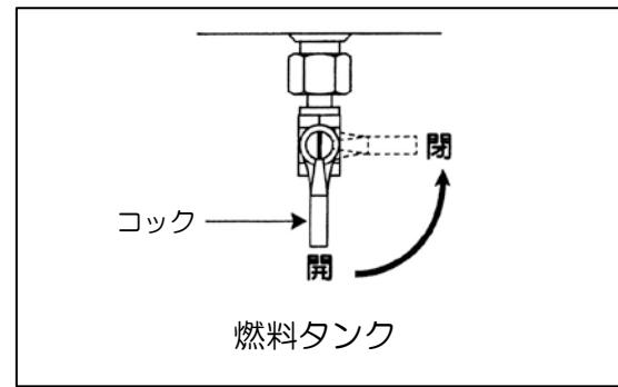
③ 燃料タンクのコックを『開』の位置に合わせ、給油ホースの先端から出てくる灯油の状態を確認してください。
