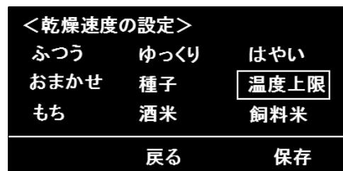
③ <温度上限設定>画面に切り替わります。ダイヤルを回して温度を変更します。
