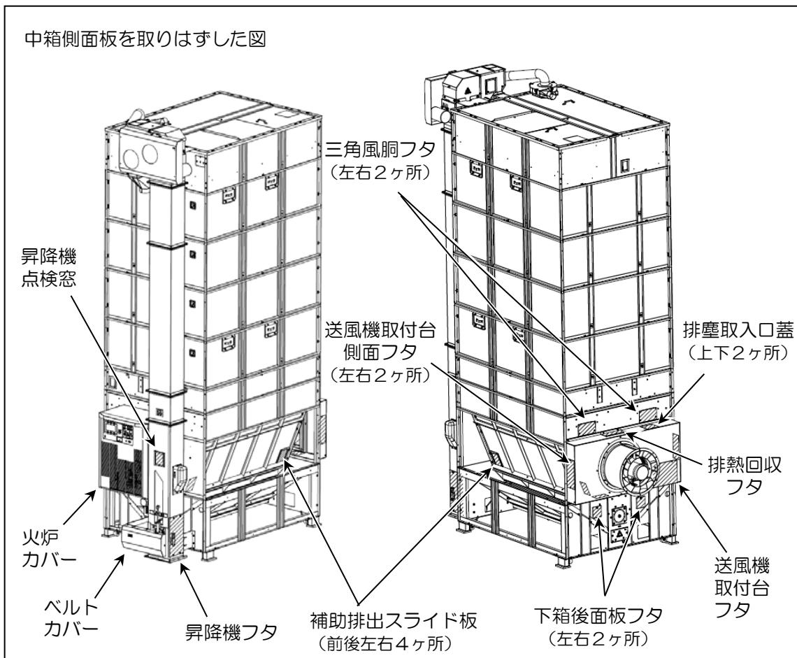
① ベルトカバー、火炉カバー、昇降機フタが取り付けられていることを確認してください。
