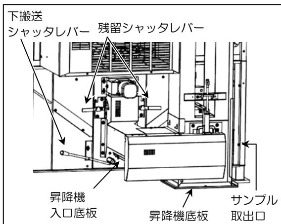
③ 残留シャッタレバー、下搬送シャッタレバー、昇降機入口底板、サンプル取出口および昇降機底板が閉じられていることを確認してください。
