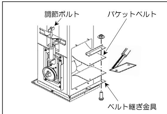
② ベルトの継ぎ代は、バケットベルトの巾程度の長さ（＝寸法B）を70～80mm残して切り取ってください。
