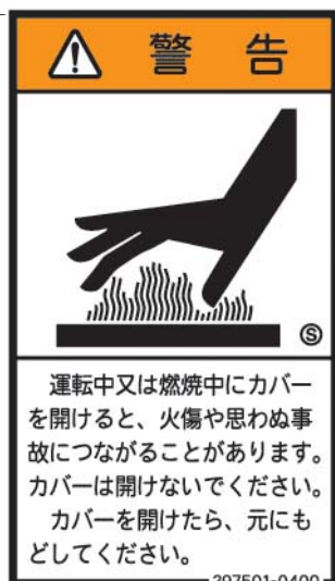
⑧ 火傷警告マーク
