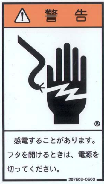
⑭ 感電警告マーク
