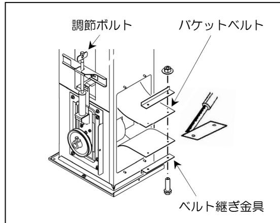
② ベルトの継ぎ代は、バケットの巾程度の長さ（＝ 寸法 B）を 70～80mm 残して切り取ってください。
