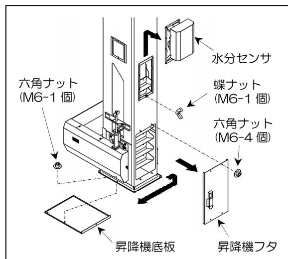
⑦ 蝶ナットを取り外して、昇降機入口底板を開き、昇降機入口下部の残留穀物を外に排出してください。
