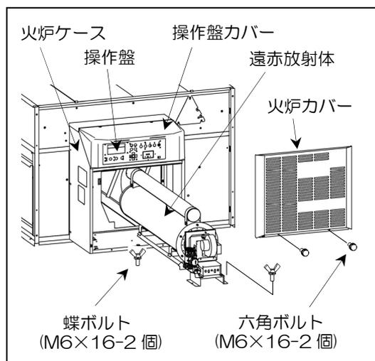
② バーナからコードをはずし、バーナを固定している蝶ボルト (M6×16-2 個) をはずしてください。
