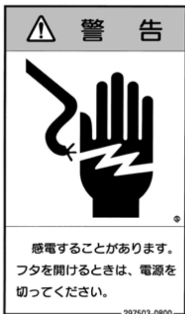
⑯ 感電警告マーク
