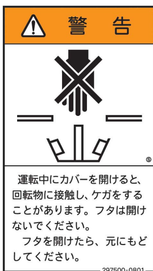
⑪ 均分機警告マーク
