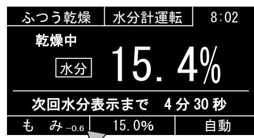
例：乾燥終了後、乾燥機の表示水分が 16.0%で手持水分計の表示水分が 15.4%の場合、乾燥機の表示水分を「-0.6% (15.4%-16.0%)」補正します。
