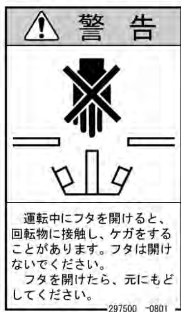
⑬ 均分機警告マーク
